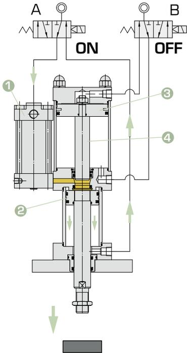
當電磁閥A通電時，壓縮空氣進入空油轉換桶 ①，使油壓活塞 ② 向前快速推進，通常油壓缸行程 100mm 最適當。
