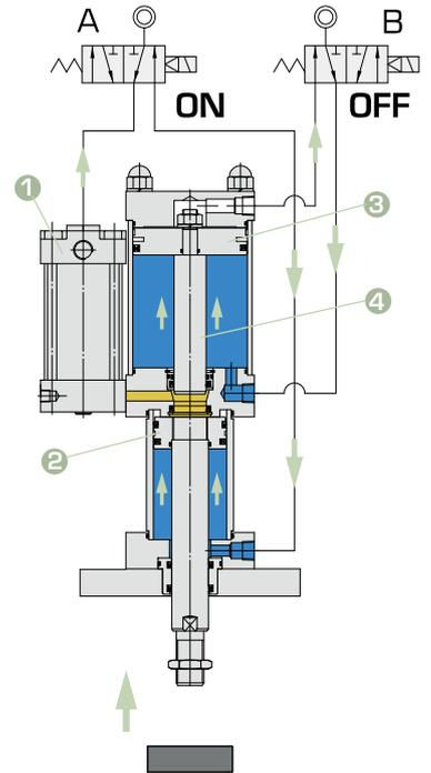
兩個電磁閥都不通電時，油壓缸和空壓缸快速退回原位，拉力為空壓拉力。
