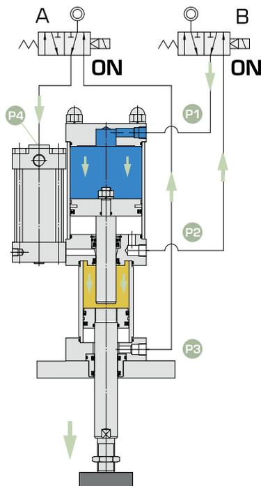
經過時間控制，電磁閥B也通電，空壓活塞 ③ 推動增壓柱塞 ④，柱塞進入油壓缸，油壓缸內油的增壓作用，使油壓缸產生高推力。高推力行程通常為5-20mm。
